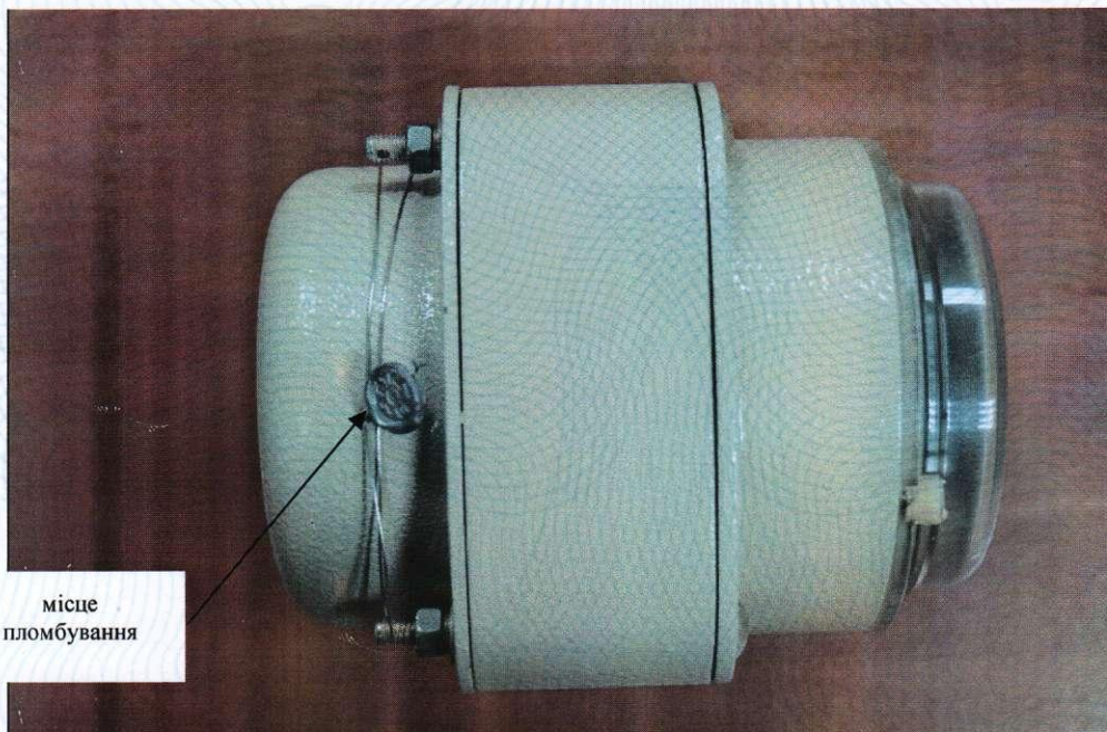
Рисунок 1 – Зовнішній вигляд лічильника, місця пломбування: рознімні з'єднання, а саме - задня кришка лічильника.
